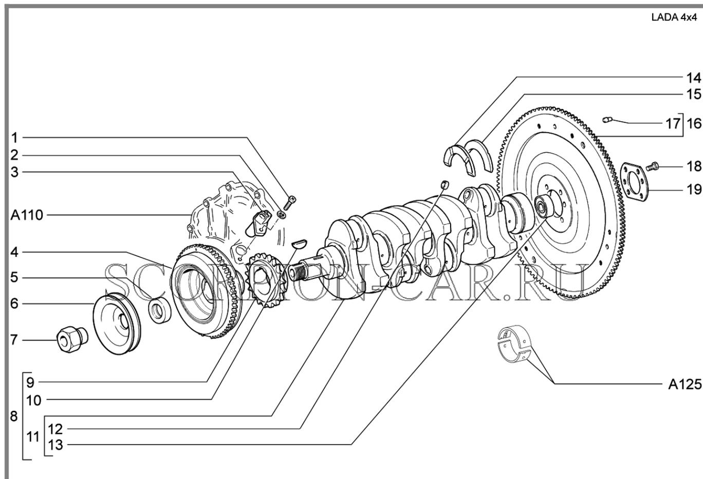
Вал коленчатый и маховик двигателя для автомобилей без КУ
