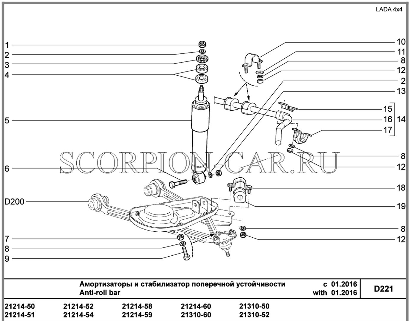
Амортизаторы и стабилизатор поперечной устойчивости
