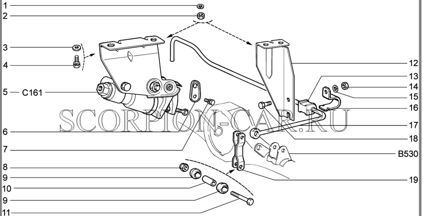
Привод регулятора давления
